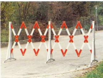
400.170 **Barrage routier réfléchissant**, extensible de 30 cm à 500 cm en aluminium avec pieds pliables, hauteur 92 cm, poids 13.5 kg. 820.00 HT
