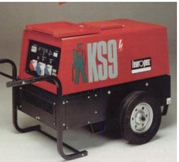
400.580 **Génératrice mobile "P 12000 "** avec moteur"HATZ " diesel démarrage électrique, équipé d'une protection thermomagnétique, d'un moniteur de contact avec la terre, voltmètre, compteur d'heures et voyant de sécurité pour la pression d'huile, réservoir de 17 lt, tension 400-230 V, puissance 12.1/7.1 KVA -17.5/30.9Amp,
