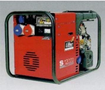
400.567 **Génératrice mobile "WFM 12000"** sur châssis tubulaire avec moteur "B&S" (benzine ) démarrage électrique, réservoir de 20 lt., tension 400-230 V, puissance 12.0 – 4.5 KVA 17.4/19.6 Amp, poids 133 Kg.
