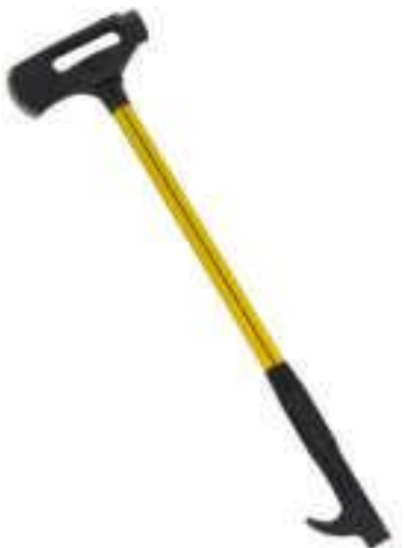
100.240 OUTIL MULTIFONCTION TNT Tool TN 840 outil de frappe multi fonction avec manche en acier recouvert de fibre de verre, pour l'éclatement des portes, des fenêtres etc. utilisable comme levier, pour couper et déchirer. fabriqué en acier trempé, poids 6 kg, longueur 102 cm
