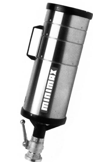
101.000 Lance pour mousse moyenne, débit 200 l/min, foisonnement 1: 75, pression de service minimale 5 bars, projection 7 m env. avec vanne d'arrêt. Type M2 508.35 HT
