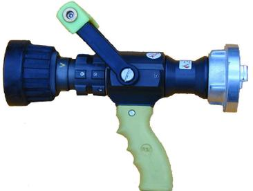
102.310 **Lance LEGENDE** débits réglables du débit d'eau à l'aide de manette de réglage comportant 7 positions de 40 à 500 l/min à 7 bars. Réglage progressif du jet plein à jet atomisé poids 1,8 kg,
