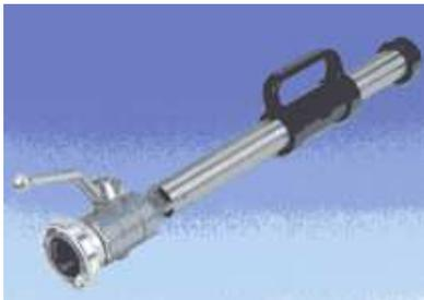
100.970 Lance pour mousse lourde, débit 200 l/m, foisonnement 1: 15 pression de service minimale 5 bars, projection 18 m env. avec vanne d'arrêt. Type S2 225.00 HT
