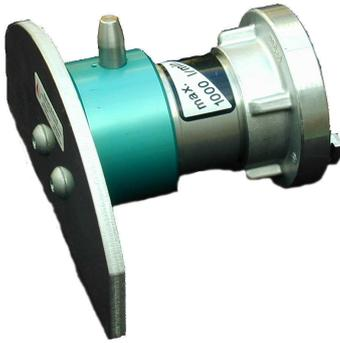
101.640 Rideau d'eau VOGT-VARIO à débit variable raccord Storz 55, à 6 bar 270 à 950 l/min, hauteur env. 10 m, largeur env. 24 m 215.00 HT
