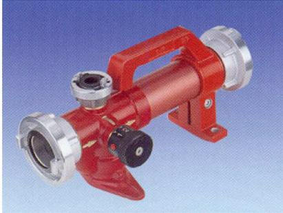
101.070 Mélangeur mousse, réglage de 0 à 5 % d'extrait, débit 200 l/m avec raccord Storz et tuyau pour l'extrait. Type Z2 531.00 HT
