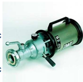
101.030 Unité portative de production de mousse multifoisonnement, dosages possibles pour émulseurs de classe A et B, compact, stable, léger (16kg plein) et anti-chocs. Capacité de 10 litres d'émulseur, pression d'utilisation 3 à 40 bar, débit 45l/mn à 7 bar, appareil multifoisonnement équipé de 3 lances interchangeable :
