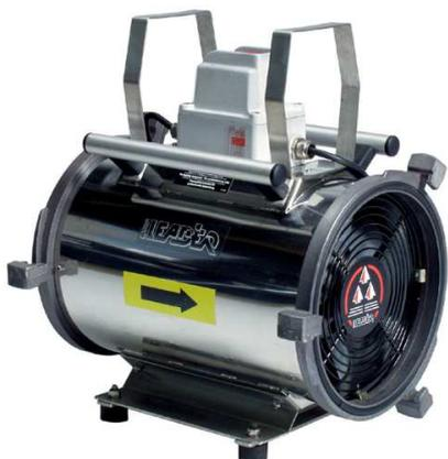
102.244 Ventilateur SAX 320 électrique soufflant ou aspirant débit en aspiration 3'150 m<sup>3</sup>/h - soufflante 9'000m<sup>3</sup>/h, turbine en résine équipé d'un moteur électrique 230V mono / 4,5A / 1100W, IP 55, EEx d IIB T4. Dim : 38 x 57,5 x 52 cm poids 37 Kg.
