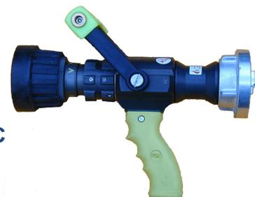
102.310 **Lance LEGENDE** débits réglables du débit d'eau à l'aide de manette de réglage comportant 7 positions de 40 à 500 l/min à 7 bars. Réglage progressif du jet plein à jet atomisé poids 1,8 kg,
