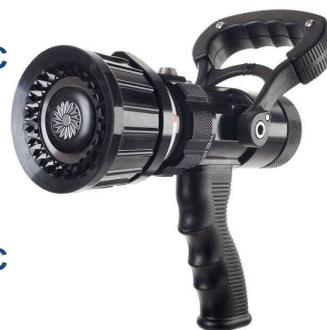
103.110 **Lance QUADRAFOG 500**, débits réglables par rotation, de la bague débit 100/250/360/475 l/min 6 bars, tête avec, protection caoutchouc jet réglable pour diffusion brouillard, en cône plein 120° à 40° " jet plein poids 1,700 kg, portée 30 m. (Production de mousse)
