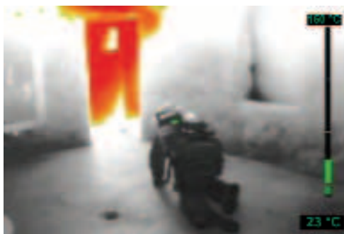
Mode Haute Sensibilité: ici les nuances de couleurs illustrent parfaitement les différences de température
