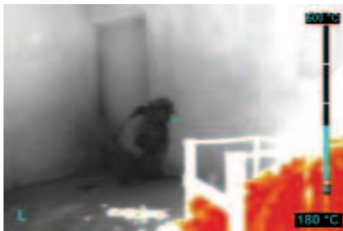
Mode Basse Sensibilité: Noter la separation des parois et du plafond
